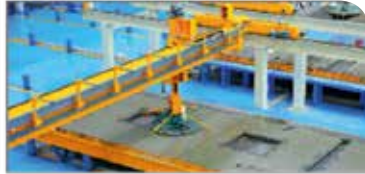
3. ผนังเรียบ สวย ประณีต ด้วยเครื่องจัดแต่งผิวหน้าคอนกรีตอัตโนมัติ
