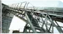
6. สายพานลำเลียงหินทรายระบบปิด ลดฝุ่น เป็นมิตรกับสิ่งแวดล้อม
